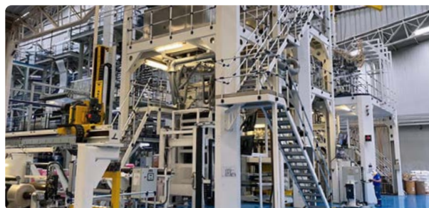
Coextrusora 11 capas con tecnología de triple burbuja
